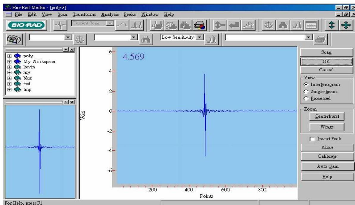
3. 按下 **Align**(Alignment) → **Calibration** → **Auto gain**，完成光學系統校正，顯示值：5~7。
