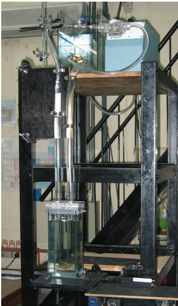
圖二 實驗室自行設計製造的心臟血管主動脈弓動態流場實驗模擬設備。
